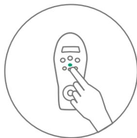
Dazu muss einfach die Taste "M" auf der Steuerung gedrückt werden, um eine neue Neigung des Rollstuhls einzustellen.
